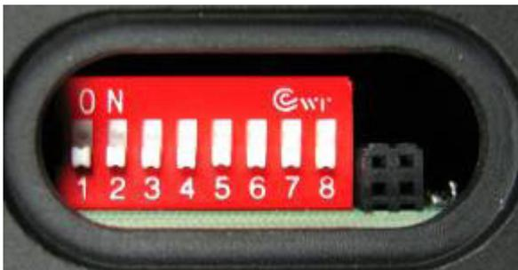
Abb. 1: DIP-Schalter (alle Schalter auf „0“)
